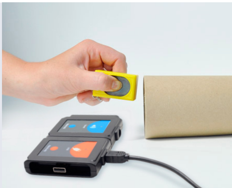
Měření rychlosti zvuku (pomocí echa)
