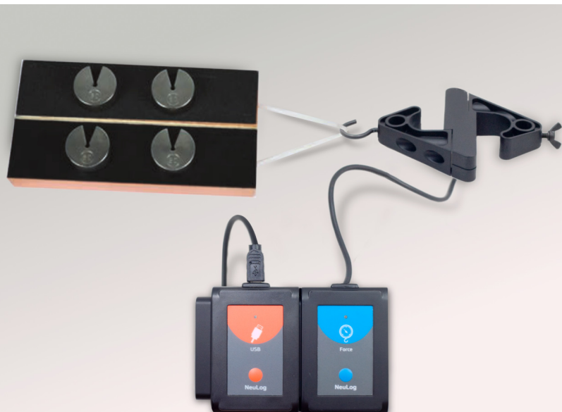
Měření třecí síly
