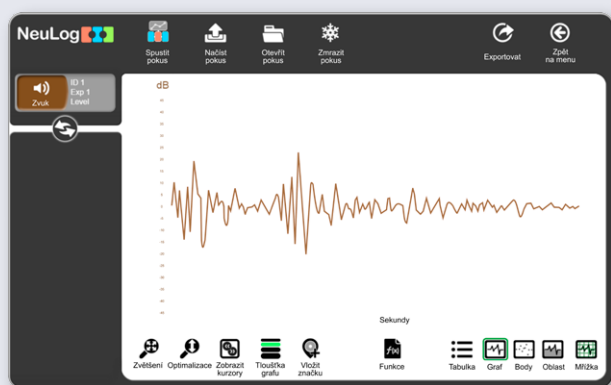
Měření rychlosti zvuku (pomocí echa)
